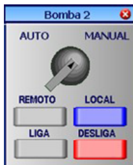
Caixa de comando de bomba
