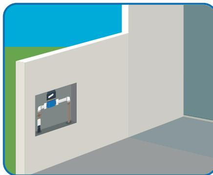
Quando o fechamento da fachada da residência for feito por grade ou similar, em vez de muro, deve ser construído um trecho em alvenaria para a instalação da caixa, garantindo livre acesso da concessionária ao hidrômetro.
